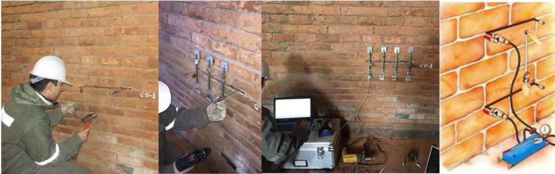
Figura 20: Fotos de realización del ensayo con gatos planos en el Templo Parroquial San José de Pelarco, Chile
